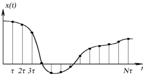
Рис. 1. Дискретизация сигнала
