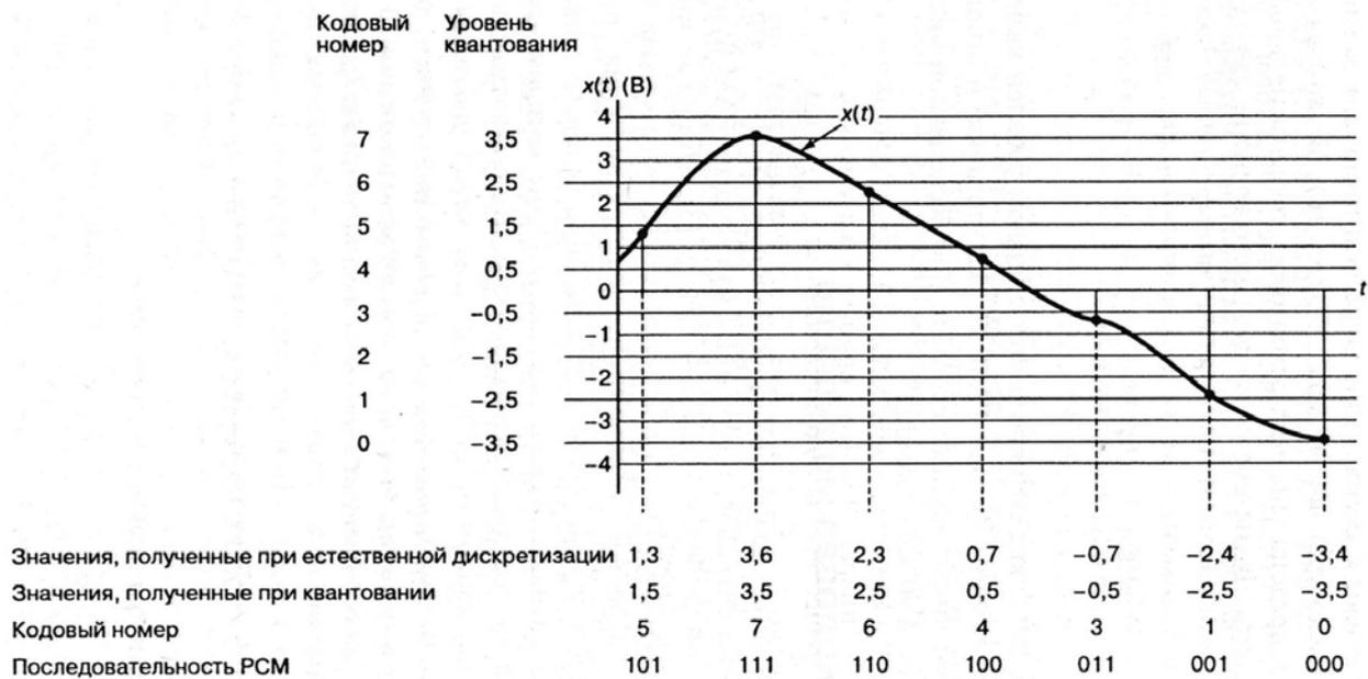
Рис. 4. Импульсно-кодовая модуляция
